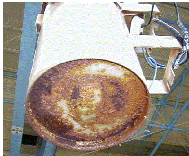
調査の一例（柱上変圧器の外箱の錆状況のデータ蓄積）
