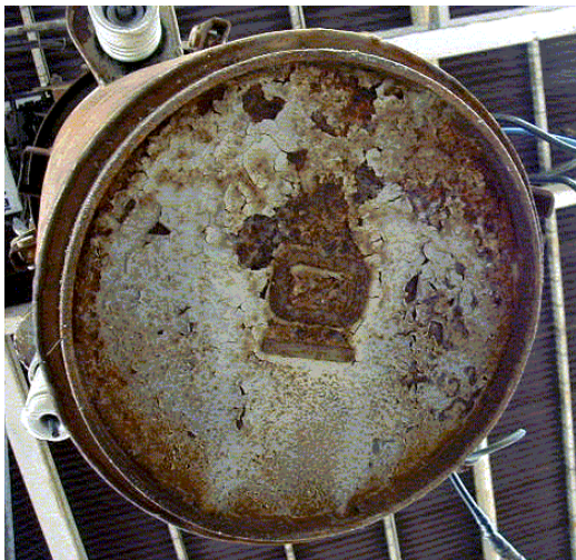
調査の一例（柱上変圧器の外箱の錆状況のデータ蓄積）
