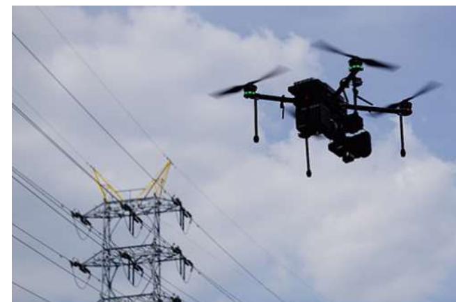
▲ドローン技術を活用した設備点検
